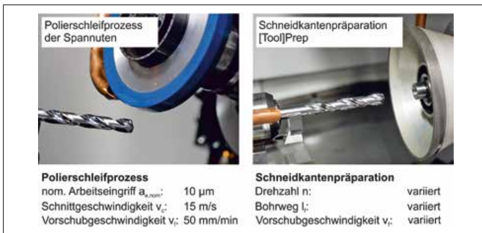
Abbildung 1: Polierschleifen der Spannuten und Präparation der Schneidkanten durch [Tool]Prep
