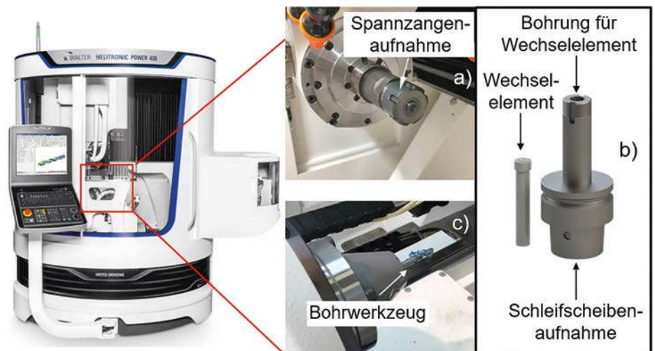
Abbildung 4: Umsetzung für die Feldversuche auf einer Walter Helitronic Power 400 a) [Tool]Prep mit Spannzangenaufnahme für Feldversuch b) Starterset des [Tool]Prep-Verfahrens mit spezieller Schleifscheibenaufnahme und c) Bohrwerkzeug nach dem Präparationsprozess
